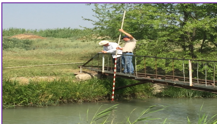
Фото 1.6.3 – Выполнение замера с гидрометрического мостика гидрометрической вертушкой ГР-21-М и вычисление расхода воды в фиксированном сечении коллектора К-1
